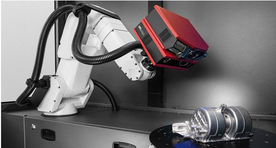
Figura 22 - Dispositivo di scansione ottica. (dal web: Produttore GOM mod.4105-2013-5)
